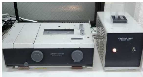
図1 研修で用いる分光光度計
