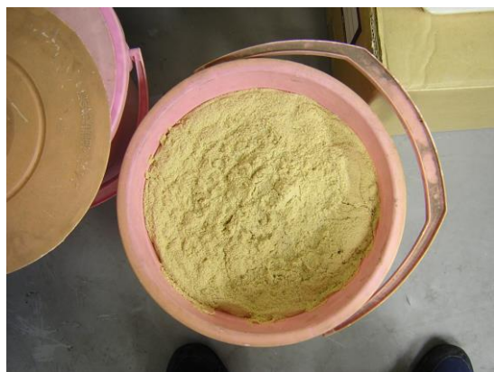
図12 コンポストによる含フェノール廃液の処理
