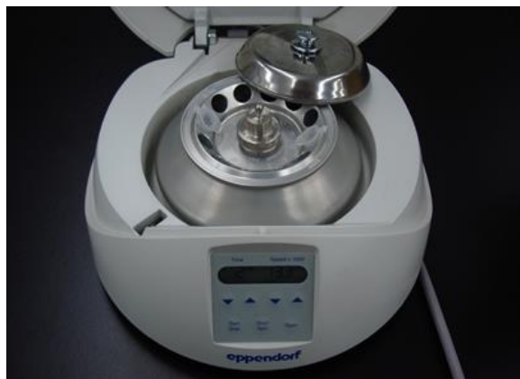
図5 卓上遠心分離器（13,000rpmが可能） チューブへ移し、遠心分離（13,300rpm、5分）
