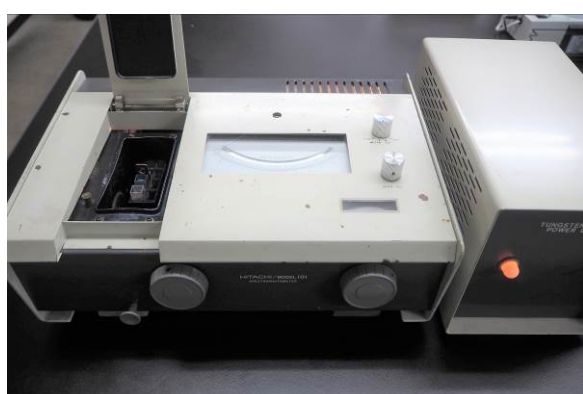
図 実験に用いた Hitachi 101 型分光光度計 (50 年程度昔の機種であるが、故障も無く現在でも現役で活躍中の優れた分光光度計)
