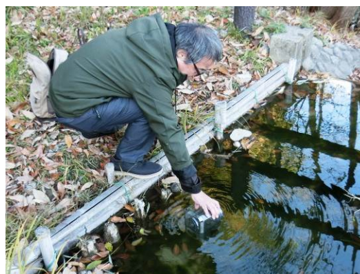
図1 ポリエチレンビンでの採水
