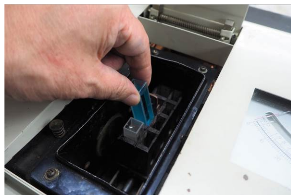
図 インドフェノール法で青色に発色したサンプルの入っているセルを分光光度計の試料室にセットするようす。
