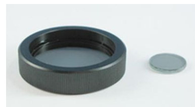
左：ポラライザ、右：アナライザ 図2 簡易偏光装置（レイマー純正）
