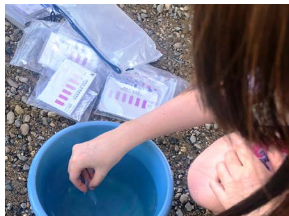
図 3.3.4 簡易水質検査試薬での測定
