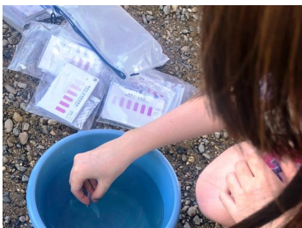
図 3.3.4 簡易水質検査試薬での測定
